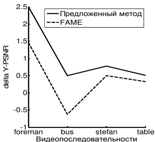
Сравнение предложенного метода и алгоритма FAME [1] с алгоритмом E3DRS [3] (по вертикали – разность значений Y-PSNR соответствующего метода и E3DRS; чем выше качество, тем больше значение метрики).
