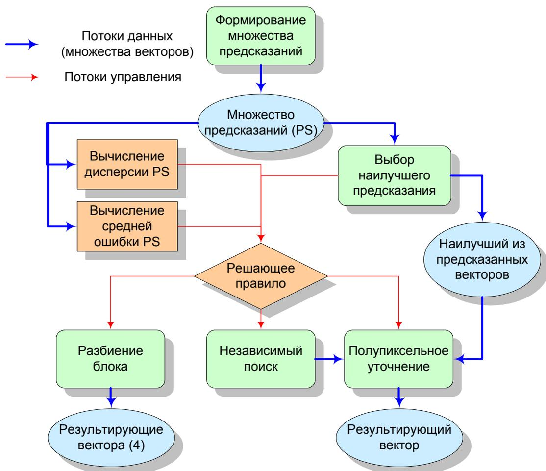
Рисунок 1. Схема работы предложенного алгоритма.
