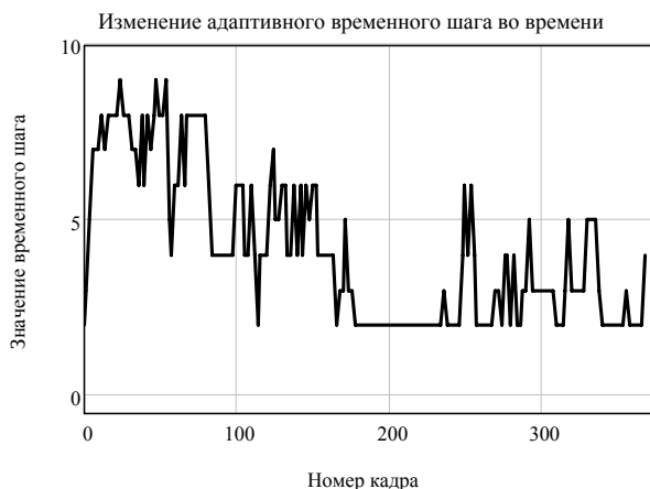
Рисунок 2: Динамика изменения временного шага k во времени на примере видеопоследовательности «mobile calendar»
