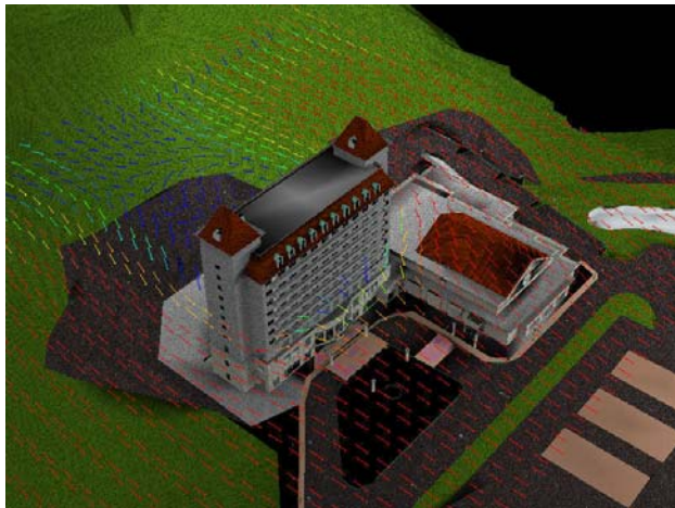
Рис.3.1. Векторное поле воздушного потока вокруг фасада здания.
