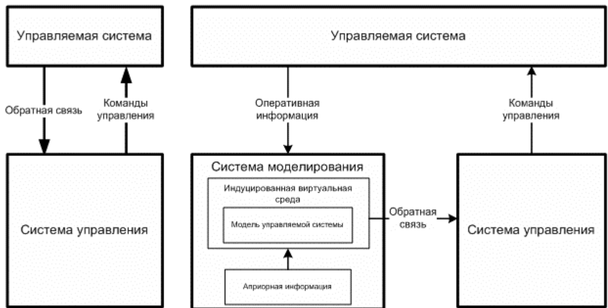
Рис. 4. Сравнение парадигм управления с обратной связью в классической постановке и с использованием ИВиС.
