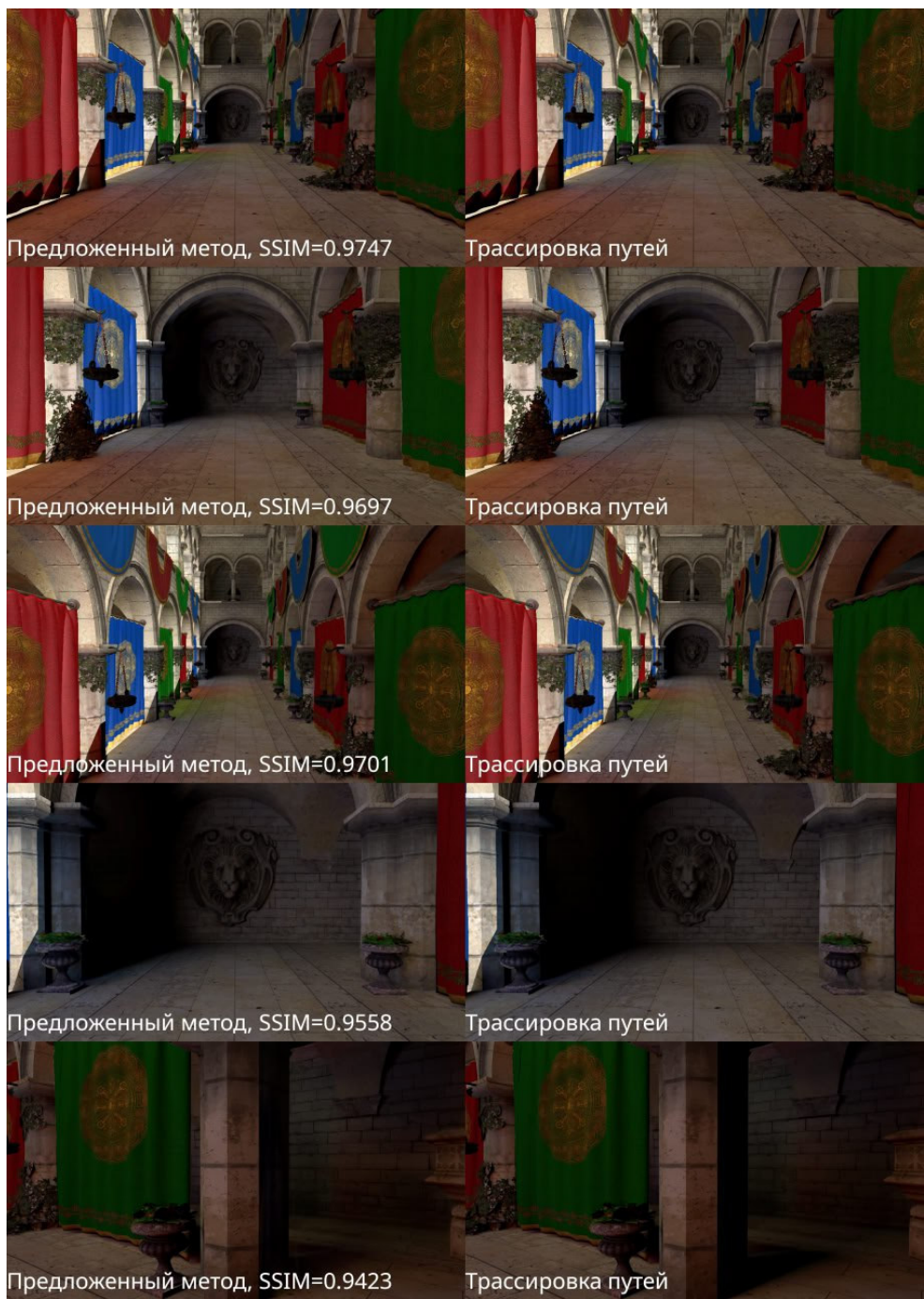
Рисунок 7. Сравнение предложенного метода и трассировки путей (эталона) по метрике SSIM
