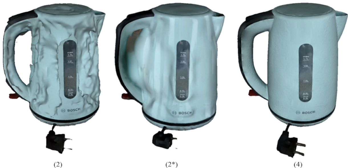
Рисунке 4. Реконструкция объекта, содержащего одноцветные гладкие поверхности конвейерами обработки: 2 – конвейером 2-го класса; 4 – конвейером 4-го класса; 2* – конвейера 2-го класса, где вместо базовой фотограмметрии на основе COLMAP и OpenMVS, использовалась платная версия модуля фотограмметрии Polycam.Inc. [Polycam]
