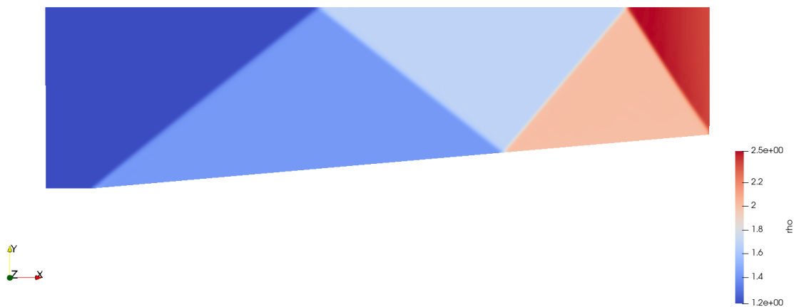
Рисунок 4. Поле плотности установившегося течения для солвера rhoCentralFoam , \beta = 10^\circ
