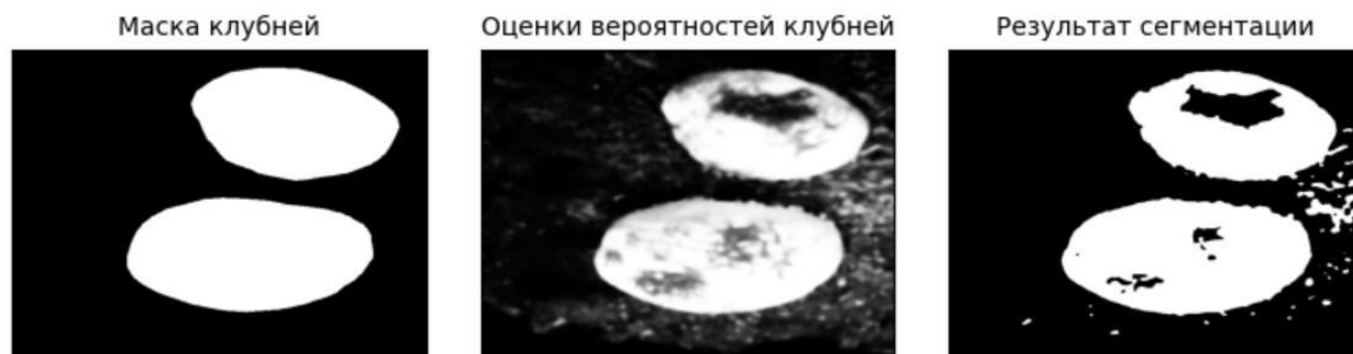
Рисунок 7. Результат сегментации тестового HSL-изображения с использованием LDA
