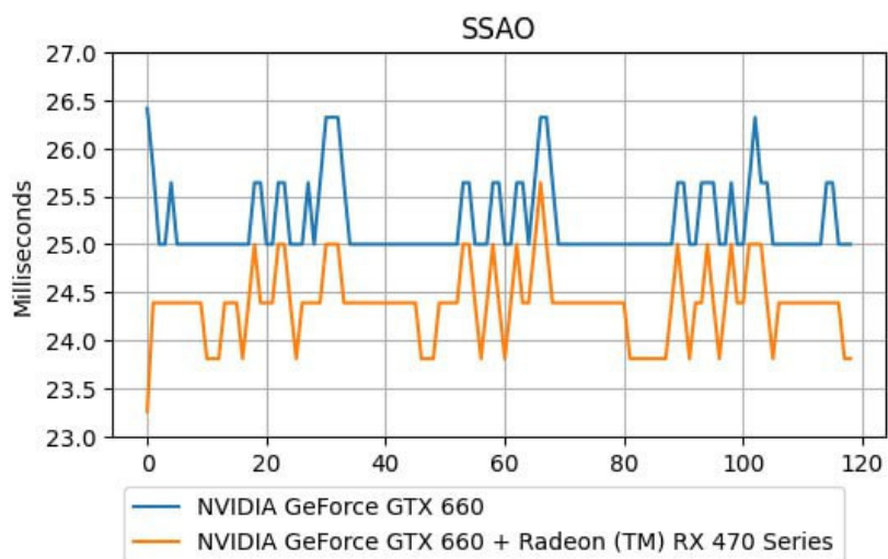
Рисунок 9. Рендер кадра при Native и Shared реализации SSAO на NVIDIA GTX 660 + AMD RX 470
