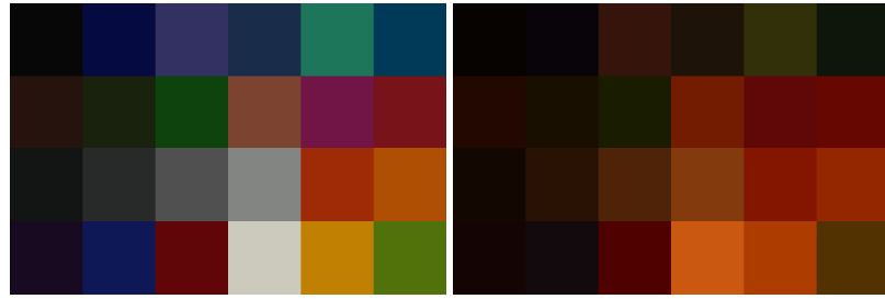
Рисунок 11. Цветовая калибровочная мишень, освещённая двумя различными источниками: D6500 и фосфорный светодиод
