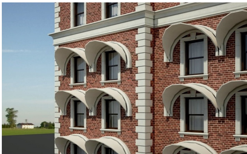
Рисунок 4. Солнцезащитные устройства в виде цилиндров
