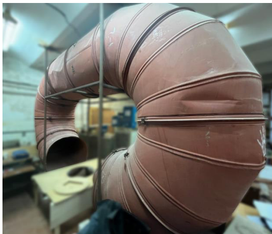
Рисунок 2. Аэродинамическая труба – прототип цифрового двойника
