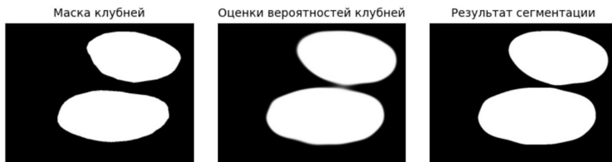
Рисунок 2. Результат сегментации тестового RGB-изображения с использованием Random Forest
