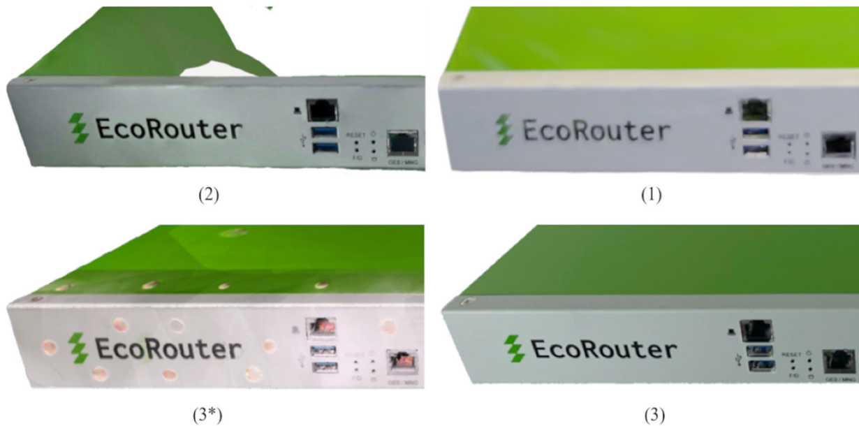
Рисунок 3. Реконструкция объекта, содержащего чёткую геометрию (чёткие углы) и чёткую текстуру (надписи, мелкие детали): 1 – конвейером 1-го класса; 2 – конвейером 2-го класса; 3 – конвейером 3-го класса; 3* – конвейером 3-го класса, с визуализацией модели, полученной непосредственно после оптического сканера без модулей T3D-текстурирования и восстановления материалов модели
