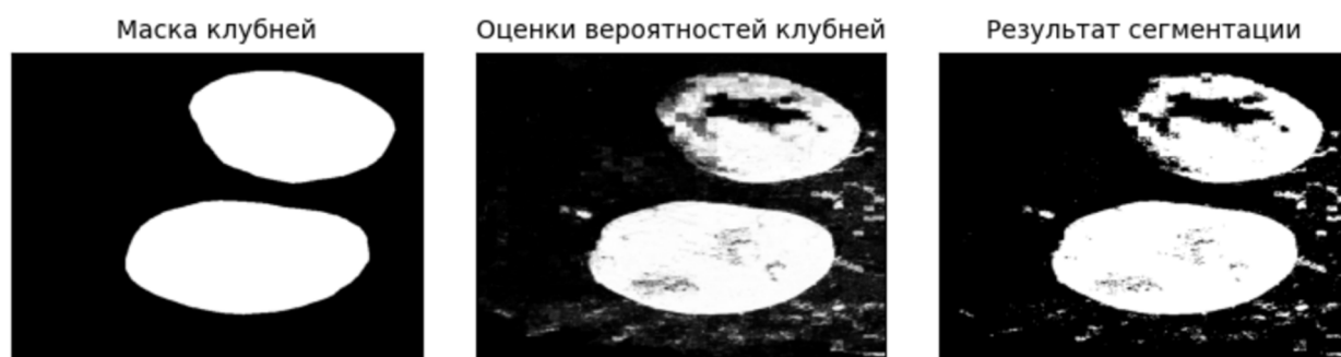
Рисунок 6. Результат сегментации тестового HSL-изображения с использованием Random Forest
