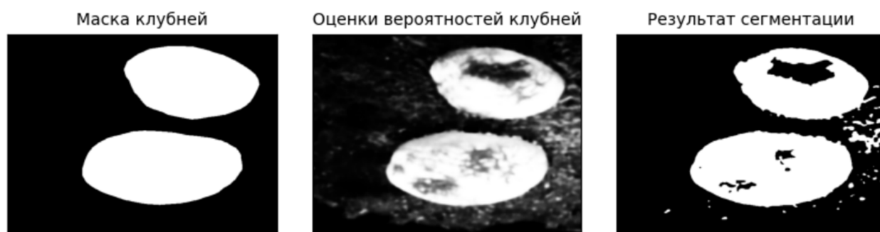
Рисунок 7. Результат сегментации тестового HSL-изображения с использованием LDA
