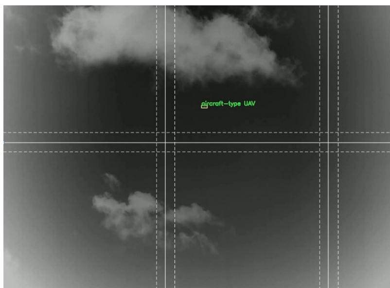
Рис. 2. Пример разделения кадра видеопотока на сегменты размером 512 \times 512 с перекрытием 10 % от размера сегмента
