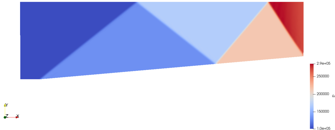
Рисунок 3. Поле давления установившегося течения для солвера rhoCentralFoam , \beta = 10^\circ
