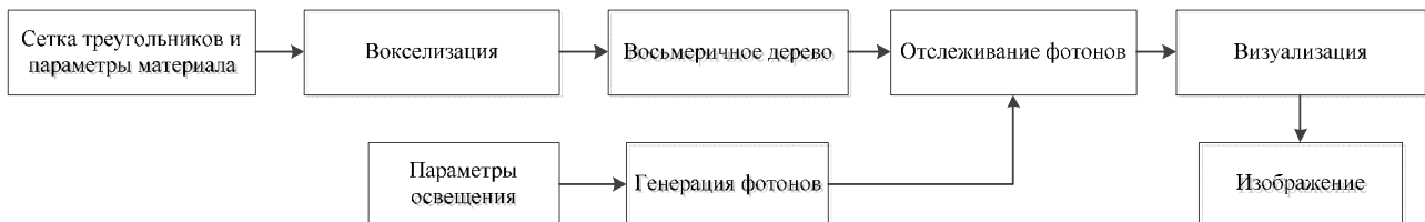
Рисунок 4. Общая схема конвейера
