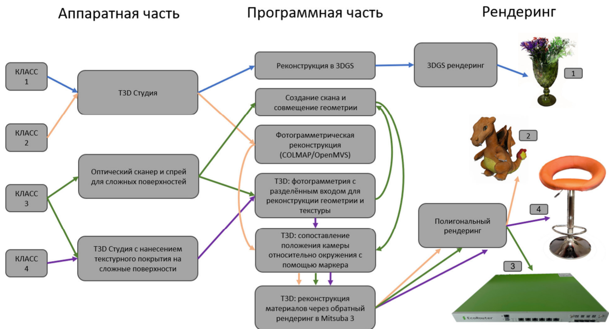
Рисунок 1. Блок-схема работы классов конвейеров обработки реконструкции объекта с предложенными модулями с отметкой «Т3Д».
