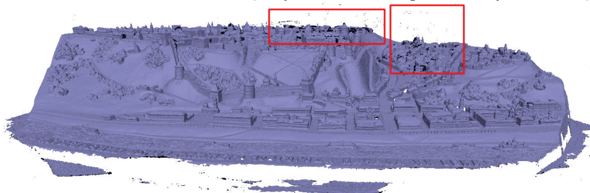
Облако точек на основе 210 снимков (построено с помощью Agisoft Metashape Professional)
