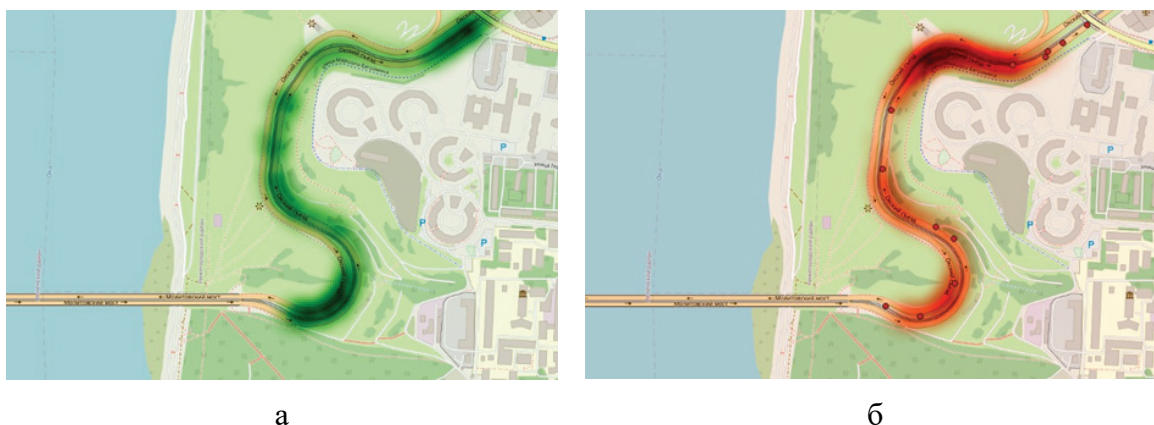
Рисунок 7 – Тепловая карта: а – перепад высот, б – радиус поворота
