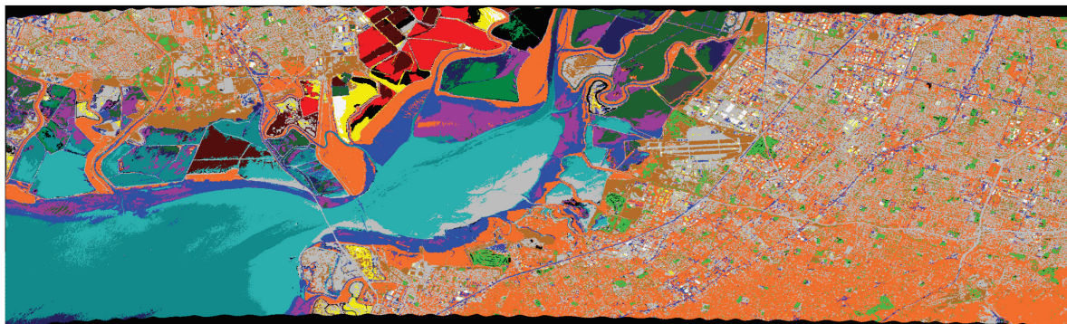
Рисунок 6 – Классификация 16 классов, эталон-референсная сигнатура за вычетом рэлеевского рассеяния, по евклидовым расстояниям ( \delta = 0.8 ). Количество неклассифицированных пикселей 1.26% от площади сканирования
