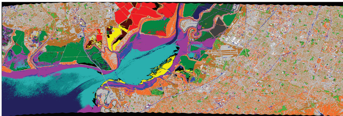
Рисунок 8 – Классификация 16 классов, эталон - конкатенация референсной сигнатуры и ее 3-й моды, мера близости к эталону - евклидово расстояние ( \delta = 0.8 ). Неклассифицированные пикселей - 0.98% сканирования
