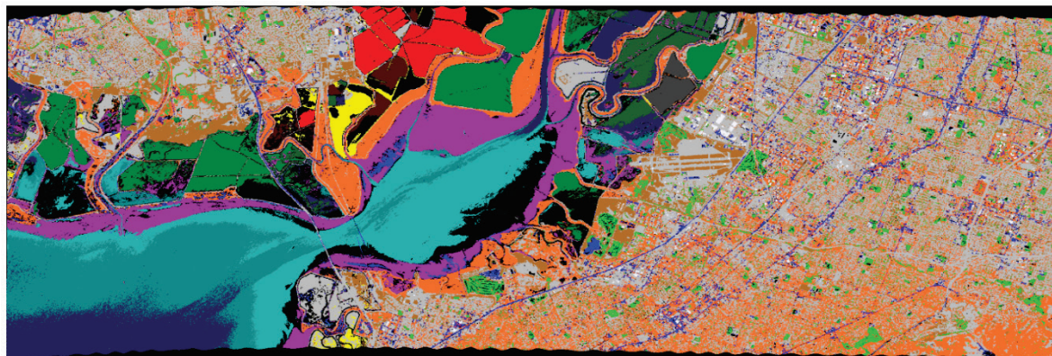
Рисунок 9 - Классификация 16 классов, эталон - конкатенация 1-й и 4-й мод, мера близости к эталону - евклидово расстояние ( \delta = 0.8 ). Количество неклассифицированных пикселей 7.72% от площади сканирования
