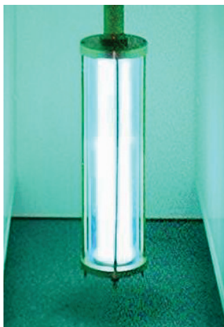
Рисунок 7 – Фотография газоразрядного источника в рабочем состоянии
