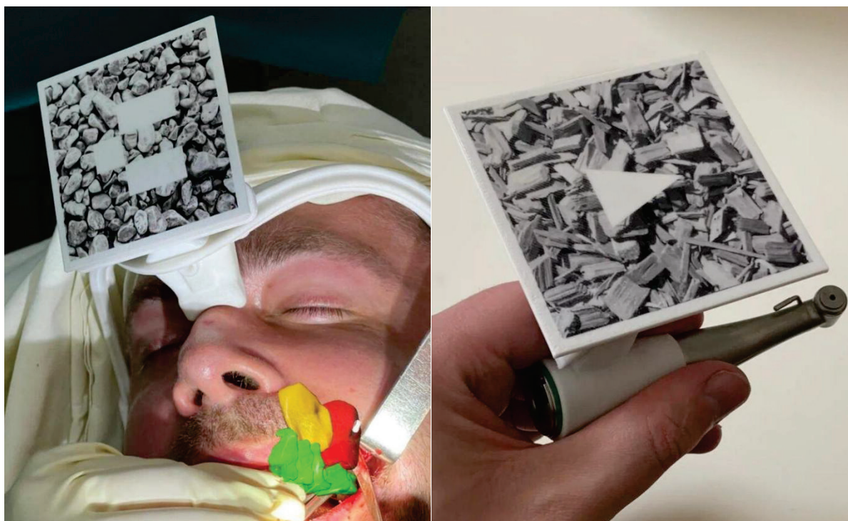
Рисунок 4 – Маркеры с контрастными асимметричными рисунками системы Medgital Vision, расположенные на теле пациента (слева) и на хирургическом инструменте (справа)
