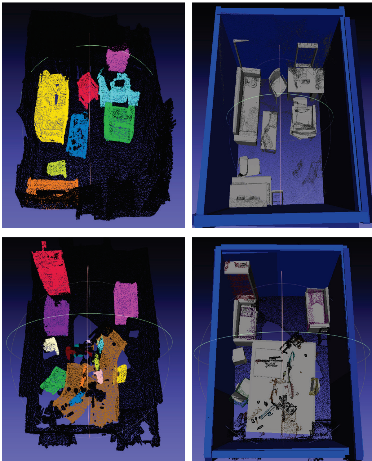
Рисунок 3 – Создание полигональных сеток объектов из облаков точек
