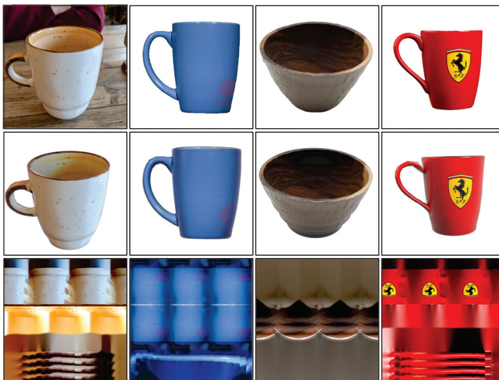
Рисунок 5 – Результаты реконструкции по одной фотографии с использованием процедурного генератора посуды. Верхний ряд: входные изображения, нижний ряд: реконструированные модели
