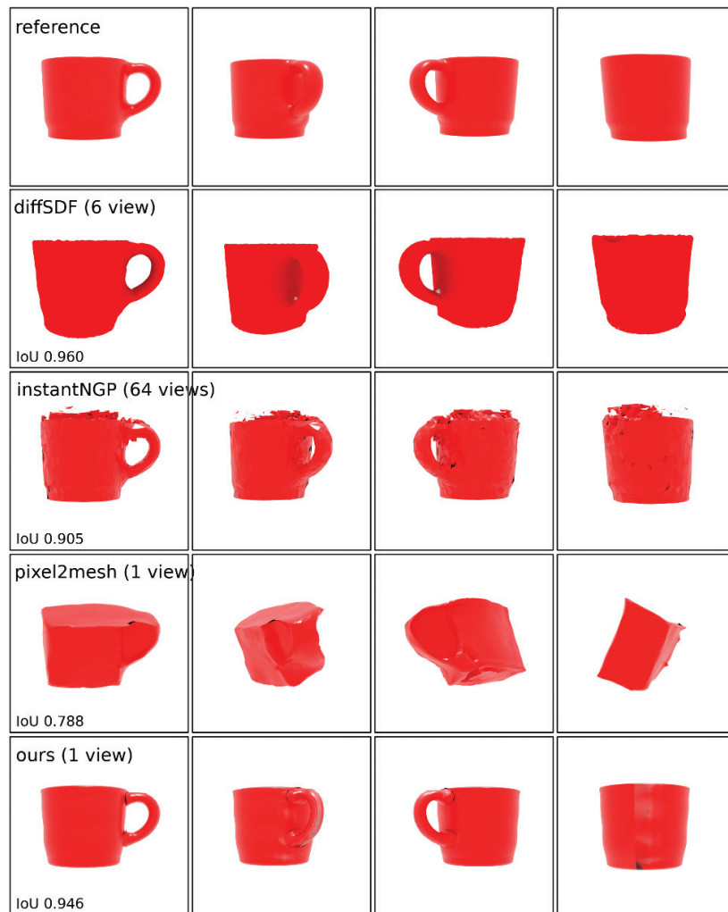
Рисунок 7 – Сравнение результатов, полученные с использованием нашего метода, с дифференцируемой реконструкцией SDF [18], InstantNGP [25] и Pixel2Mesh [3]
