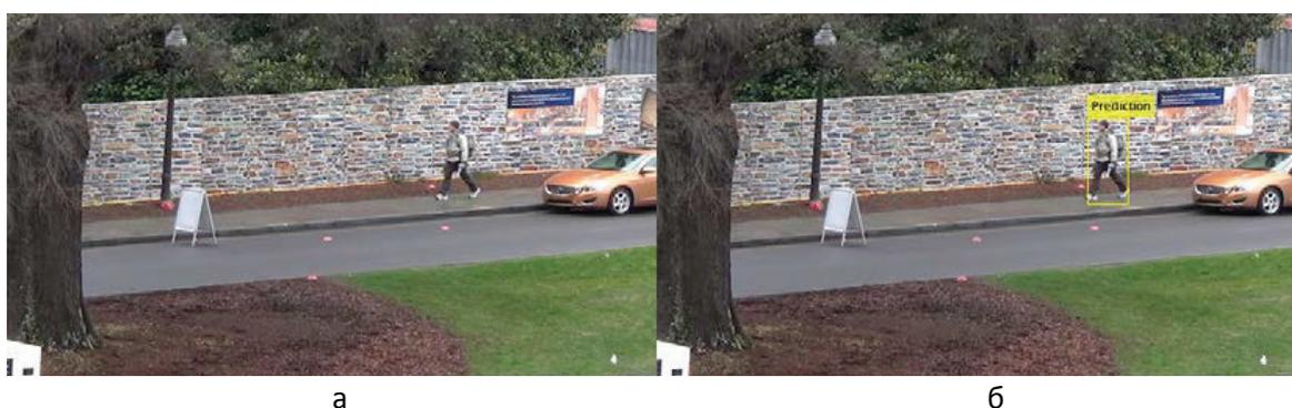
**Рисунок 3** – Пример работы алгоритма слежения: а – кадр видеопоследовательности, обработанный алгоритмом без функции слежения; б – кадр видеопоследовательности, обработанный алгоритмом с включенной функцией слежения
