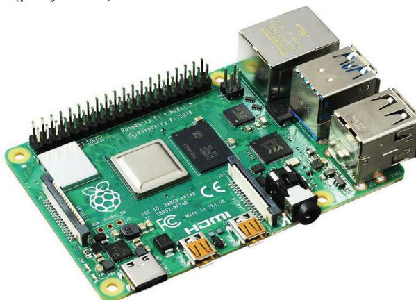
**Рисунок 4** – Raspberry Pi 4 Model B
