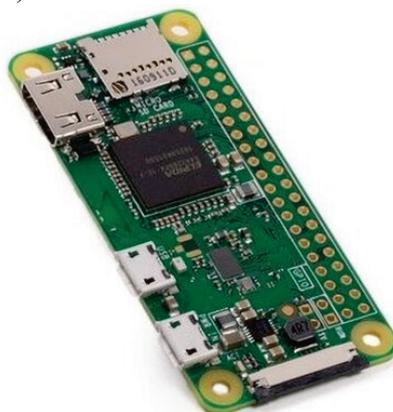
Рисунок 1 – Raspberry Pi Zero W
