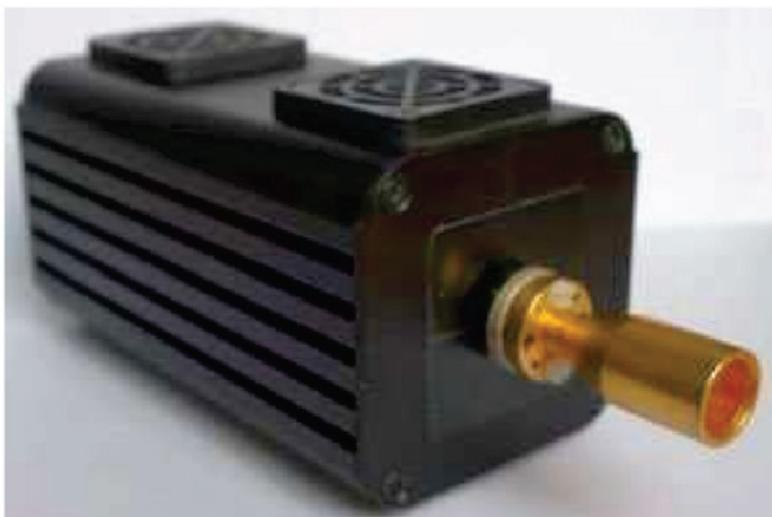
**Рисунок 2** – Генератор субтерагерцового диапазона на IMPATT-диоде с конической рупорной антенной миллиметрового диапазона «АНКР 90000-100000»
