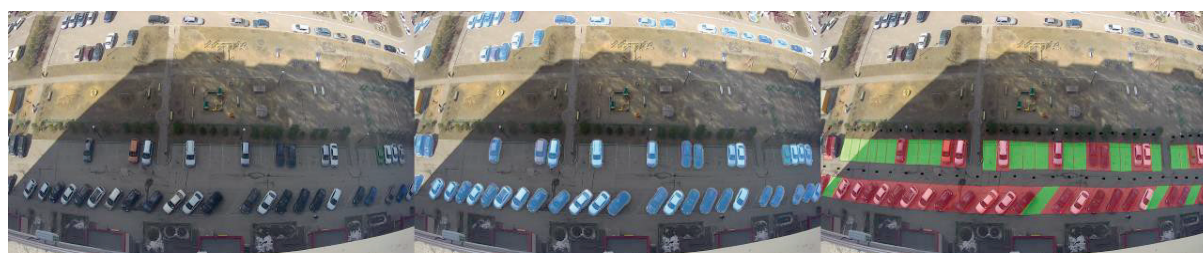
Рисунок 6 – Пример результата работы системы (съемка с большой высоты, с присутствием тени большого размера)
