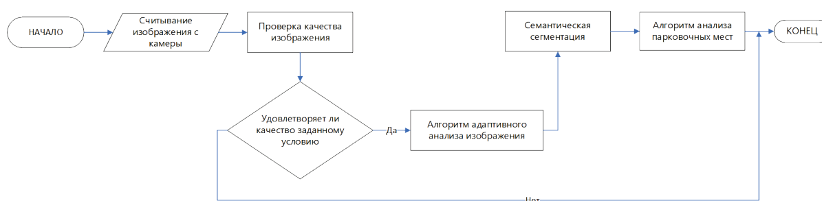
Рисунок 1 – Блок-схема алгоритма работы системы анализа парковочного пространства
