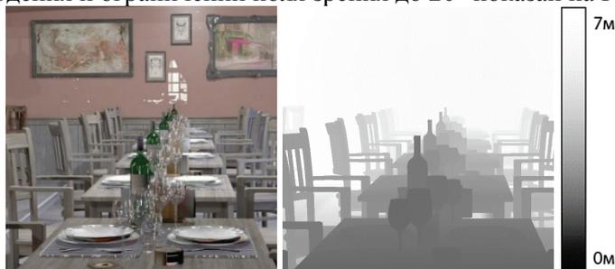
**Рисунок 8** – Изображение и карта глубин, полученные с одной центральной фронтальной RGB-D камеры на расстоянии 2м
