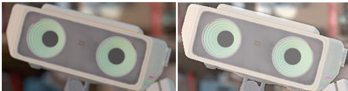
Рисунок 15 – Область изображения вблизи плоскости фокусировки, результат работы нейросетевого фильтра (слева) и адаптивного кругового фильтра (справа)
