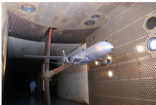
Рис. 1. Модель пассажирского самолета в рабочей части
