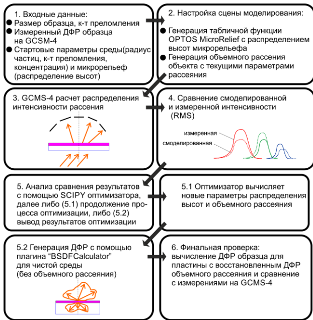
Рис.2. Обобщенная схема восстановления параметров объемного рассеяния и ДФР оптической среды.
