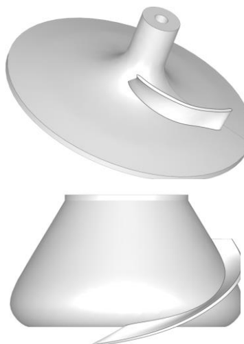
Рис. 8. Результаты реконструкции рабочего колеса турбины с одной лопаткой.
