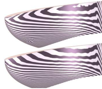
Рис. 6. Поверхность лопатки, построенная оператором сканинга без сглаживания (сверху) и со сглаживанием при \lambda = 10^{-5} (снизу). Для анализа дефектов формы использовалась «зебра».
