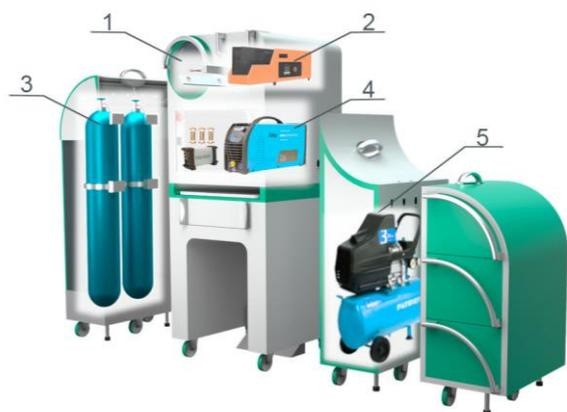
Рис. 2. Взрыв схема с внутренней комплектацией, 1- Электроды, 2-Экструдер, 3-Газовые баллоны, 4-Силовой блок, осциллограф, фильтры, экран моноблока, 5- Компрессор
