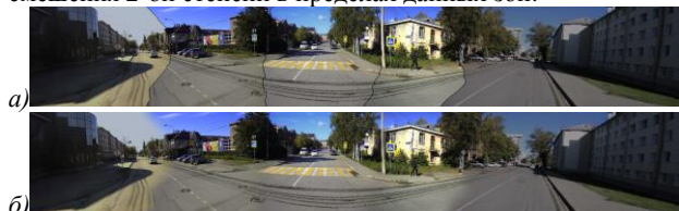
Рис. 8. Панорама с оптимальными границами сшивки и результат градиентного смещения 2-ой степени
