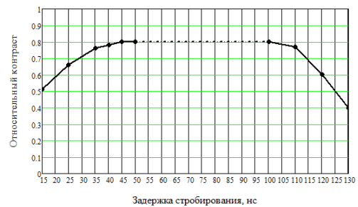
Рис. 6. График зависимости относительного контраста от задержки стробирования (чистая среда).
