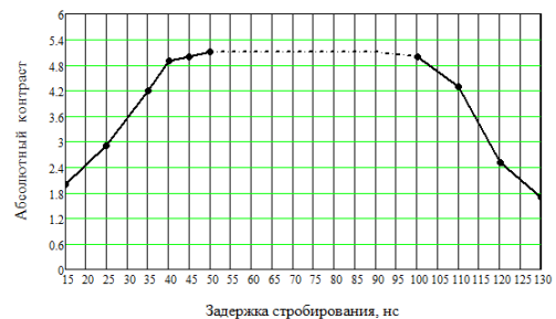
Рис. 7. График зависимости абсолютного контраста от задержки стробирования (чистая среда).
