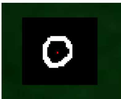
Рис. 5. Выделение контуров одиночного пузырька и определение его центра
