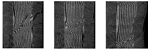
Рис. 4. Сдвиговые интерферограммы, визуализирующие конвективные структуры и фазовый переход в вертикальном слое пресной воды.
