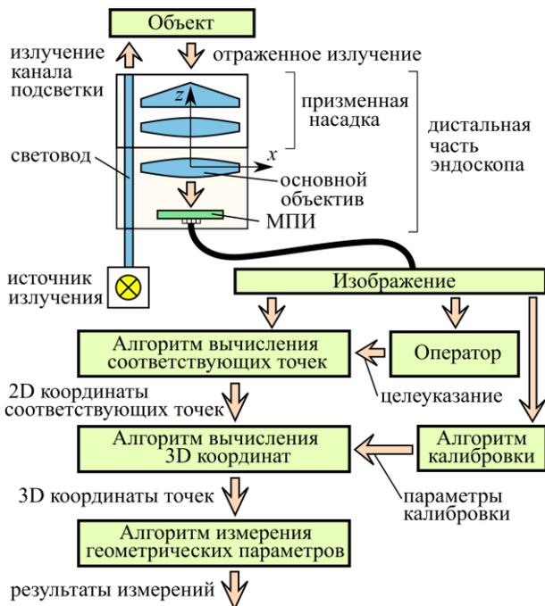
Рис. 1. Структурно-функциональная схема видеэндоскопа с призматической насадкой.
