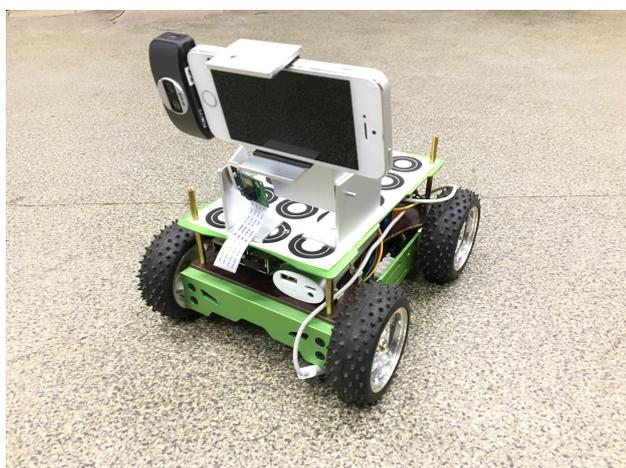
Рис. 1. Мобильный робот с многоспектральной камерой FLIR ONE
