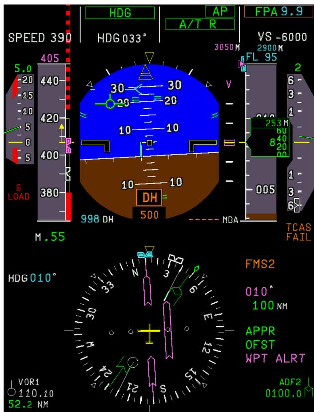
Рис. 1. Пилотажно-навигационный дисплей.
