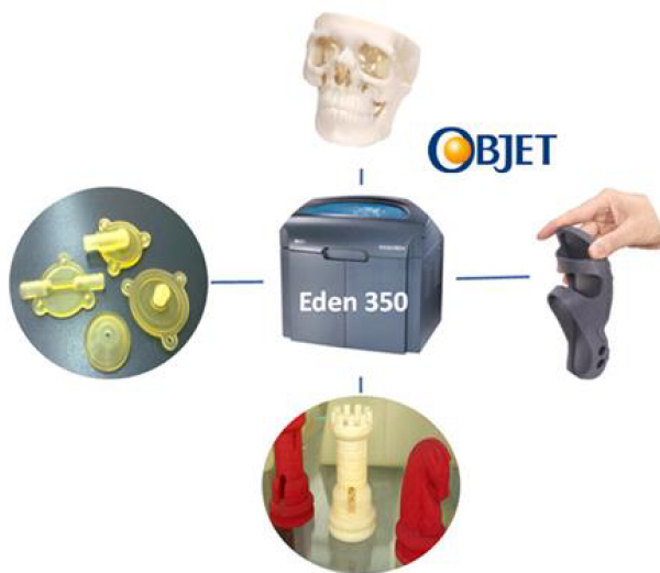
Рис. 4: Изделия, полученные печатью на Objet Eden 350
