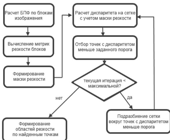
Рис. 3. Схема работы алгоритма
