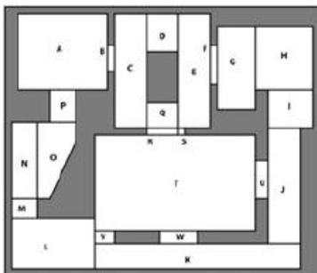
Рис. 4: Пример navigation mesh.
