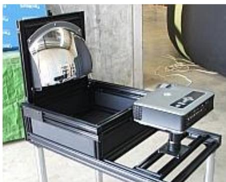
Рис. 1 Проектор и сферическое зеркало
