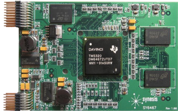
Рис 8: Однокристалльная реализация видеоаналитики на платформе Texas Instruments DaVinci TMS320DM6467. Размер платы, 80 x 55 x 14 мм, соответствует габаритам банковской карты.
