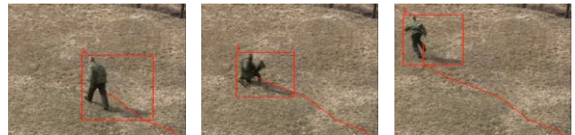
Рис 6: Сопровождение изменчивого объекта при помощи алгоритма связывания регионов
