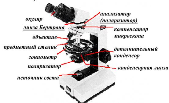
Рис. 1. Петрографический микроскоп
