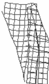
**Рисунок 4:** Изгиб горизонтальных линий сети вблизи одной из сторон вытачки
