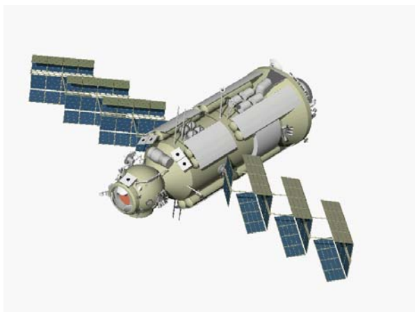
а) раскрытие панелей солнечных батарей
