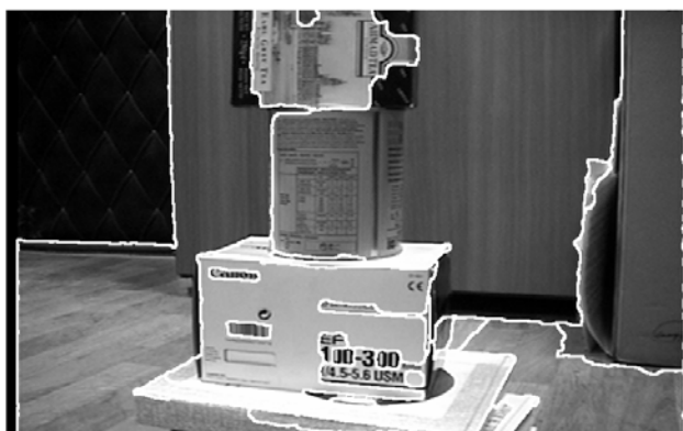
Рисунок 13. Результат уменьшения детальности сегментации на снимке с мобильного робота Pioneer-2AT (выбор стока и истока как двух сегментов наиболее отличающихся по яркости)
