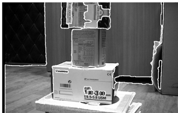
Рисунок 12. Результат уменьшения детальности сегментации на снимке с мобильного робота Pioneer-2AT (выбор стока и истока по разные стороны от наиболее сильной границы)
