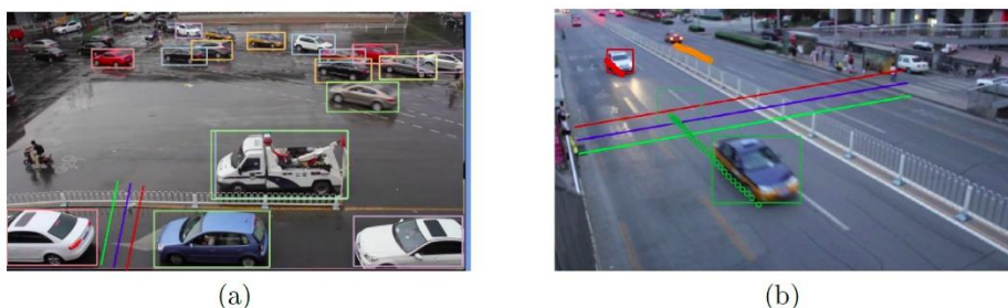
Рис. 2. (a) Визуализация работы детектора. На белом фургоне в центре кадра 2 обнаружения различных классов (b) Визуализация траекторий и их пересечений с сигнальным отрезком
