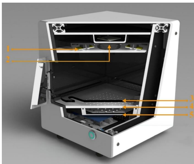
Рис. 1. Аппаратно-программный комплекс: 1 – верхний источник излучения, 2 – камера с объективом, 3 – кассета для размещения образцов зерна, 4 – светорассеивающая пластина, 5 – нижний источник излучения
