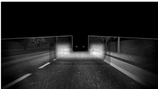
Рисунок 2. Совмещение изображения поля зрения водителя с результатом анализа распределения освещённости.
