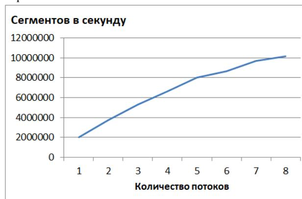
Рис. 5. Зависимость скорости обработки трехмерной карты лучей от количества используемых потоков.
