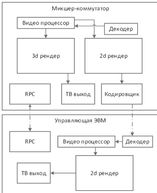
Рис. 2: Схема взаимодействия между программными модулями системы.
